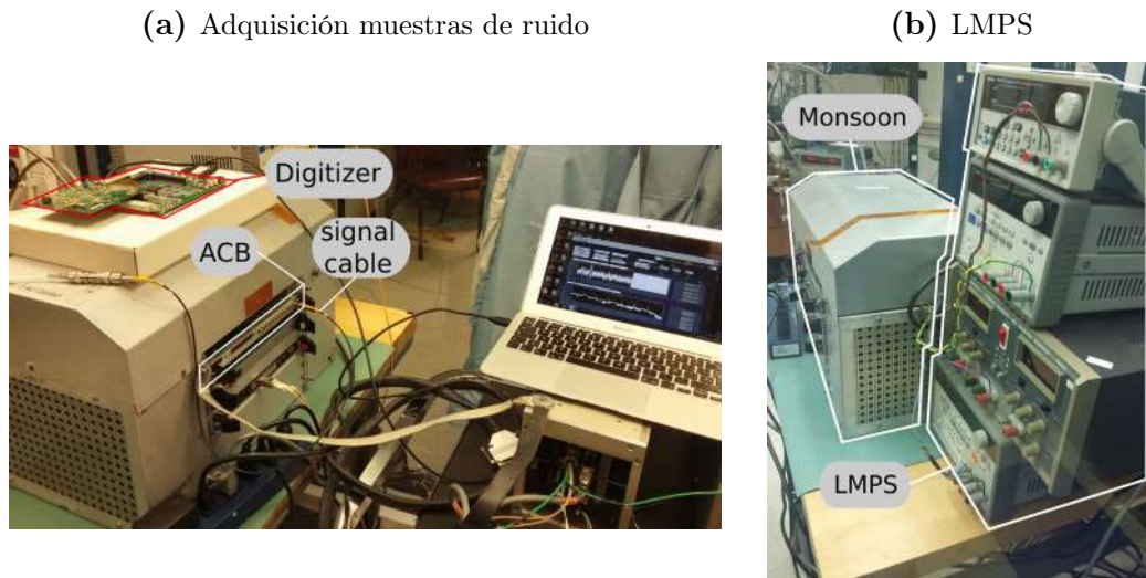
Figura 4.16: a) arreglo experimental para adquirir muestras de ruido a la salida de la cadena de adquisición. b) sistema de lectura Monsoon alimentado con fuentes lineales.
