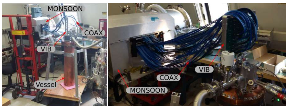
Figura 4.12: Prueba realizada en el laboratorio del detector de CONNIE-100 g, se muestra el vessel donde se encuentran CCD, la VIB y el sistema Monsoon que se conecta a la VIB mediante cables coaxiales.
