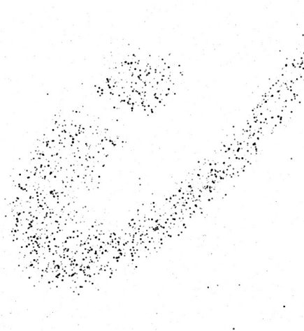
Figura 16. Imagen en negativo tomada interponiendo una hoja de papel con el recorte del logo del Instituto Balseiro, entre la fuente de ^{241}\text{Am} y el CCD. Las partículas \alpha no atraviesan la hoja y por lo tanto, sólo pueden pasar por el recorte hasta el CCD. Sin embargo, se observa señal fuera de dicha región que está generada por los rayos \gamma de hasta 60 keV que también emite la fuente.
