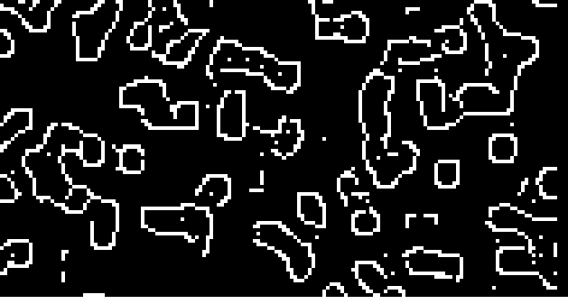
Figura 22. Porción de una imagen con eventos \alpha , luego de haber sido procesada por el algoritmo de Canny dedetección de bordes. Cuando se mira el perímetro de los eventos se tiene una forma natural de diferenciar los eventos aislados de los alglomerados.
