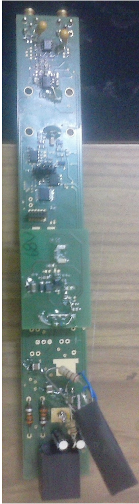
Figura 15: Placa de electrónica utilizada para alimentar el SiPM y amplificar la corriente generada por este. La salida del circuito estaba dada por pulsos de tensión, como los que se ven en la figura 13.
