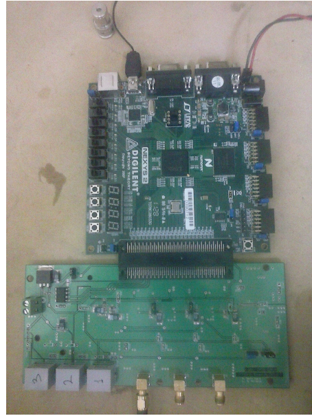
Figura 16: Placa de LAGO utilizada para la adquisición de datos.
