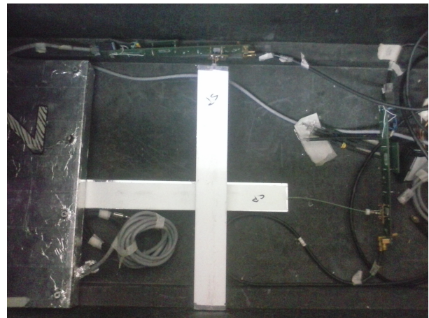
Figura 35: Fotografía del sistema de medición. Se ven las dos barras centelladoras blancas, con un Silicon PM adosado a cada una
