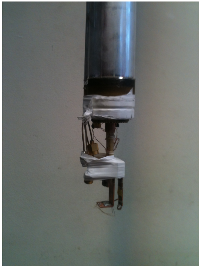
Figura 14: Disposición de la muestra en contacto con el dedo frío del crióstato, junto con el termómetro. La muestra se ubica horizontalmente en la parte inferior y dispuestos verticalmente se observan el termómetro y el dedo frío.
